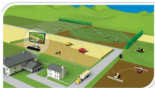
Figur 3. Trimbles' svar på hvordan man kan holde styr på en stor bedrift med mange maskiner og arbejdsopgaver. Data overføres trådløst begge veje mellem traktor og kontor og mellem traktorer.
